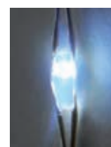
Microled spessore 2 mm
