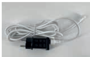
Alimentatore a spina Schuko IP44 e cavo d'alimentazione H03VV - F 2x0,75 mm 2 L= 3m con connettore standard LYVIA BT. Adatto per alimentare sino a 5 stringhe PRLB.
