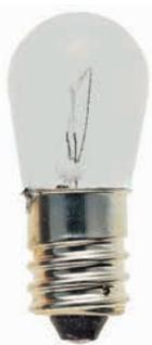
Sui portalampe E14 sono montate le lampadine tipo gocciola 14 V - 5 W, con contatto permanente (art. 60220). Quando una lampadina si spegne, le altre rimangono accese (è importante, però, sostituire subito la lampadina bruciata per evitare il sovraccarico sulle altre).
