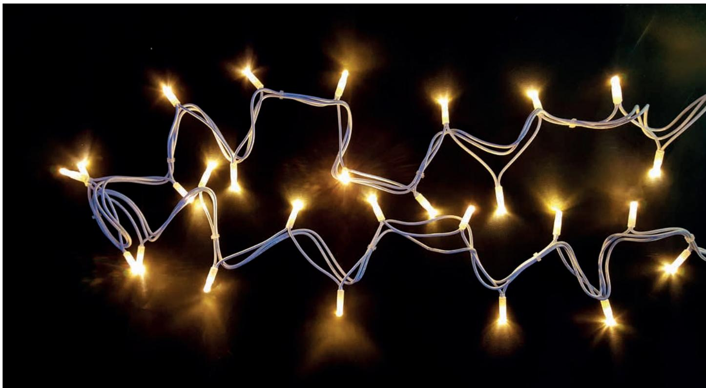
Stringa luminosa, con 40 LED ad alta luminosità e **protetti contro gli urti accidentali**, costruita secondo le norme EN 60598-2-20. Cavo in gomma H03RN-F - Ø 0,50 mm<sup>2</sup>, doppio isolamento, autoestinguente, prolungabile tramite connettori. **La stringa viene fornita senza cavo d'alimentazione.**
