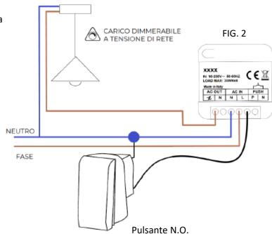
Una volta collegato un pulsante normalmente aperto come da FIG. 1 o 2, è possibile dimmerare il carico (lampade ad incandescenza e/o dispositivi a led dimmerabili a taglio di fase secondo la seguente modalità:
