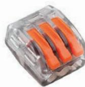
Ideali per realizzare in maniera pratica e veloce collegamenti equipotenziali di conduttori flessibili e rigidi con sezioni da 0,5 a 4 mm<sup>2</sup> e per tensioni sino a 450V e correnti max 32 A.
